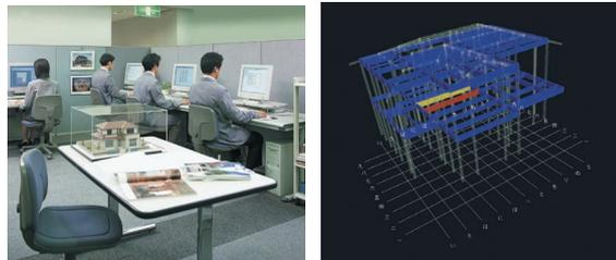
構造計算(災害シミュレーション)で一棟一棟を厳しくチェック。最新の建築構造知識を持った専門家が、「テクノストラクチャー構造計算」(388のチェック項目、多雪地域は440項目)に基づき、地震・台風・豪雪等で建物が受ける影響を事前検証します。
